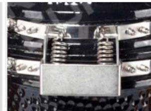
6. Пружинный механизм открывания
